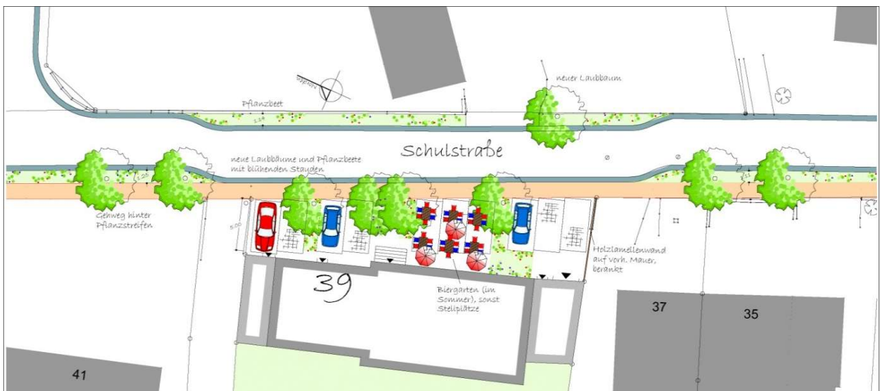
Fahrbahnverschwenk und Schaffung von Grünflächen mit Gehweg südlich der Straße (und vor einer Gaststätte)
